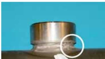
Дефекты сварки приводят к снижению гидравлических характеристик, шуму и низкой производительности. Некачественные сварные швы, окалина и пережог подвергают соприкасающиеся поверхности риску коррозии и сокращают срок службы всей установки.
