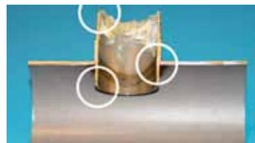
Прерывистые сварные швы приводят к появлению трещин. Неправильное применение клея для винтовой резьбы способствует заражению перекачиваемой жидкости бактериями.
