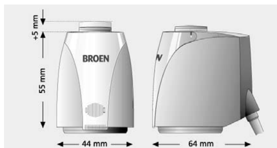
Рис.3.18. Габаритные размеры привода
