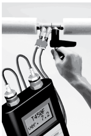
Рис.1.4. Измерение расхода на клапане BALLOREX® Venturi
