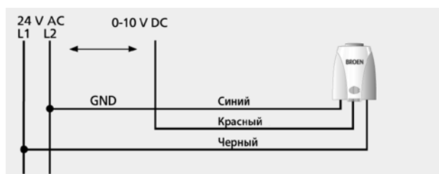
Рис.3.20. Схема подключения привода
