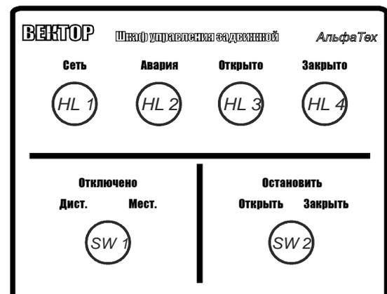
Рисунок 2.13. Типовая компоновка шкафа управления 2<sup>мн</sup> электрифицированными задвижками
