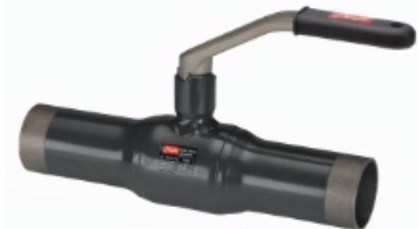
Краны JIP-WW - двухпозиционная запорная арматура со сварным соединением. Краны специально разработанны для систем централизованного теплоснабжения и горячего водоснабжения, в которых вода очищена с целью избежания коррозии. Также краны применимы для систем холодоснабжения.
