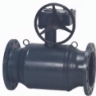
Краны JIP-FF - двухпозиционная запорная арматура с фланцевым соединением. Краны были специально разработанны для систем централизованного теплоснабжения и горячего водоснабжения, в которых вода специально очищена с целью избежания коррозии. Также краны применимы для систем холодоснабжения.
