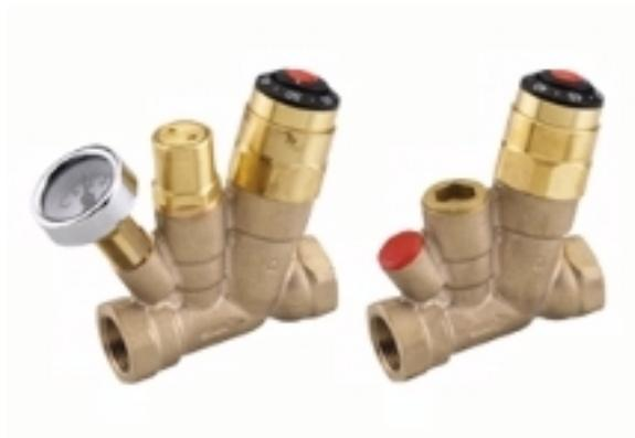
Термостатический балансирующий клапан МТСV — регулятор температуры прямого действия. Он предназначен для стабилизации температуры и минимизации расхода воды в циркуляционных стояках систем горячего водоснабжения (ГВС).
